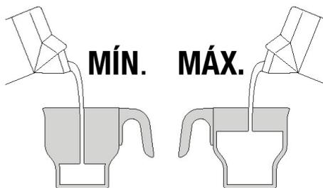
Las diferentes marcas de la jarra para leche le permiten obtener resultados óptimos. El cuadro de la derecha muestra el número aproximado de tazas producidas para cada una de las marcas de medición. Esta es solo una guía. Debe considerar que la cantidad de espuma que se produce varía en función del disco espumador seleccionado y el tipo de leche (entera (vitamina D), semidescremada, descremada, light, etc.)
