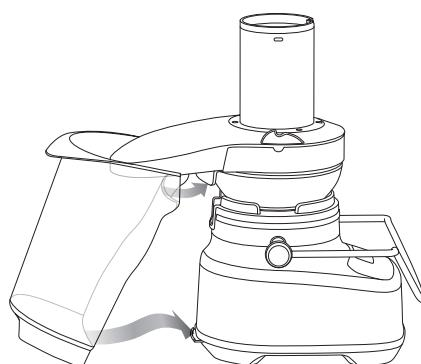
8. El tapón de goteo se puede poner sobre la boquilla de salida de jugo. Luego permite que la salida se conecte para evitar goteos después de extraer el jugo.
