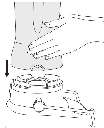
2. Levante el brazo de bloqueo de seguridad y ubíquelo en las dos ranuras a cada lado de la cubierta de la licuadora.
