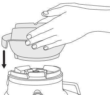
2. Alignez les flèches sur la base du panier filtre en acier inoxydable avec les flèches sur le couplage d'entraînement du moteur et appuyez jusqu'à ce que le panier filtre s'enclenche et soit bien fixé sur le socle motorisé.
