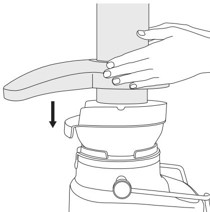
4. Levante el brazo de bloqueo de seguridad y ubíquelo en las dos ranuras a cada lado de la cubierta del exprimidor.
