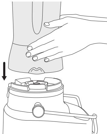
2. Soulevez le bras de verrouillage de sécurité et placez-le dans les deux rainures situées de part et d'autre du couvercle du mélangeur.
