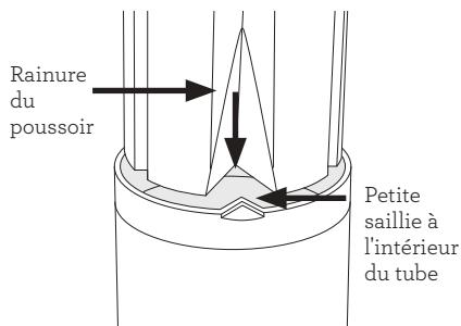
7. Placez le contenant à pulpe à sa place en inclinant et en soulevant légèrement le socle motorisé. Insérez-le sous le couvercle de l'extracteur en veillant à ce que le bord avant soit rentré sous le bord arrière du bol du panier filtre et que le côté inférieur soit clippé dans le bas du socle motorisé.
