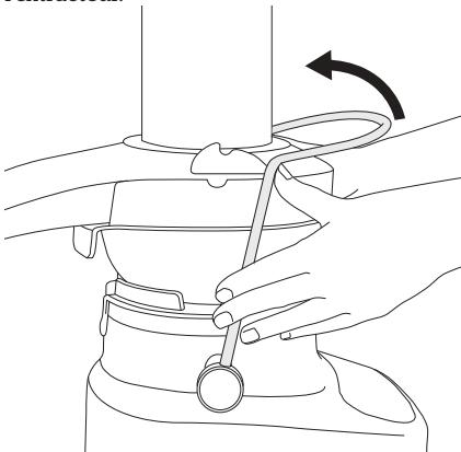
5. Le bras de verrouillage de sécurité devrait maintenant être en position verticale et bien verrouillé sur le couvercle de l'extracteur.
