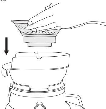
3. Placez le couvercle de l'extracteur sur le bol du panier filtre, en positionnant la partie inférieure du tube d'alimentation au-dessus du panier filtre en acier inoxydable.
