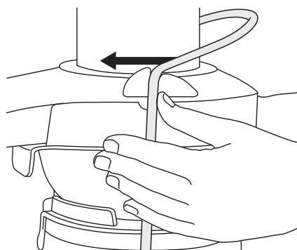
6. Deslice el empujador de alimentos hacia abajo por el tubo de alimentos, de modo que la ranura en el empujador de alimentos se alinee con la pequeña protuberancia en el interior de la parte superior del tubo para alimentos.
