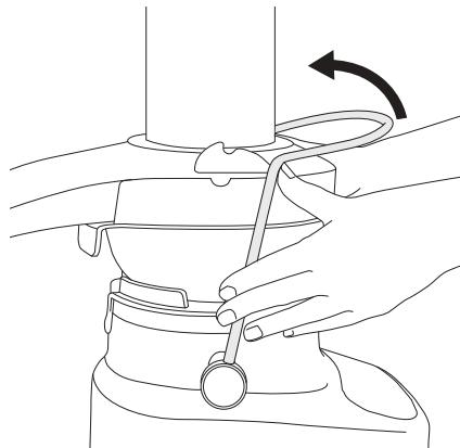
5. El brazo de bloqueo de seguridad ahora debería estar en posición vertical y asegurado en su lugar en la parte superior de la cubierta del exprimidor.
