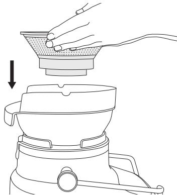
3. Coloque la cubierta del exprimidor sobre el bol de recubrimiento del filtro, para que la parte inferior del tubo para alimentos quede sobre el bol de recubrimiento del filtro de acero inoxidable.
