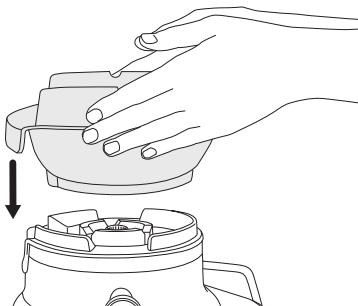
2. Alinee las flechas en la base del filtro de acero inoxidable con las flechas en el acople del motor y empuje hacia abajo hasta que encaje en su lugar para crear un ajuste seguro con la base del motor.
