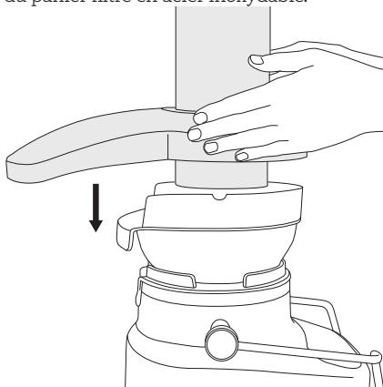
4. Soulevez le bras de verrouillage de sécurité et placez-le dans les deux rainures situées de part et d'autre du couvercle de l'extracteur.
