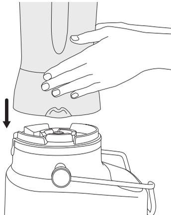
2. Levante el brazo de bloqueo de seguridad y ubíquelo en las dos ranuras a cada lado de la cubierta de la licuadora.
