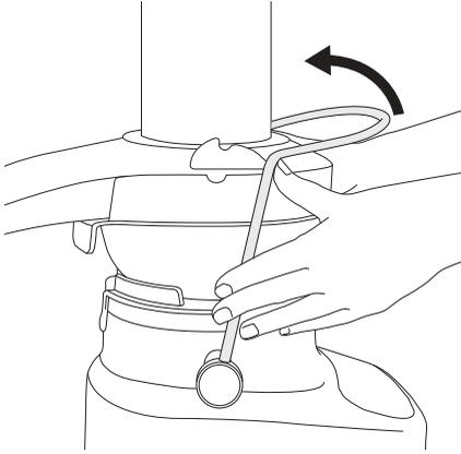
5. El brazo de bloqueo de seguridad ahora debería estar en posición vertical y asegurado en su lugar en la parte superior de la cubierta del exprimidor.
