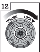
12 Verrouiller la meule supérieure
