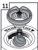
11 Enfoncer la meule supérieure en place
