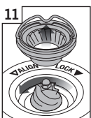
11 Enfoncer la meule supérieure en place
