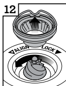
12 Enfoncez la meule supérieure en place
